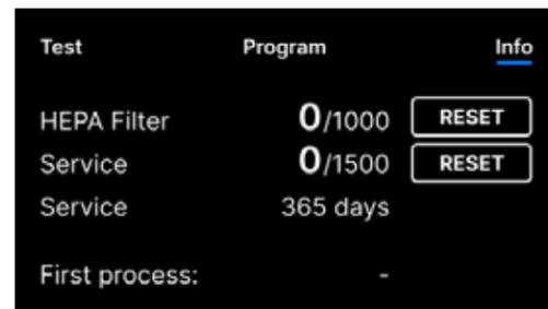
Section des compteurs avec les compteurs remis à zéro. Le nombre de processus effectués est indiqué à gauche, tandis qu'à droite se trouve le nombre à partir duquel le composant doit être remplacé ou une inspection de service doit être effectuée. Après avoir remplacé le filtre, l'utilisateur peut remettre les valeurs à zéro en appuyant sur le bouton RESET. La valeur du contrôle de service ne peut être réinitialisée que par un technicien de service agréé.
