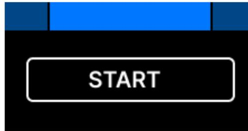
Lorsque la chambre est fermée en tournant le bouton de verrouillage dans le sens des aiguilles d'une montre, le symbole START apparaît sur l'écran, ce qui informe que la chambre est correctement fermée.
