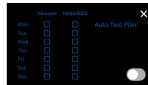
Pour activer le plan de test automatique, appuyez sur le commutateur à bascule. Le calendrier hebdomadaire et le cadran horaire s'affichent.
