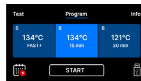
La marque rouge sur l'icône rappelle à l'utilisateur qu'il doit fermer les portes avant de partir. Le test automatique ne démarre pas lorsque les portes sont ouvertes.
