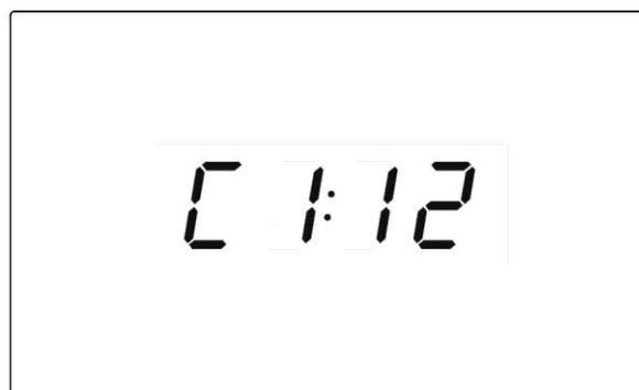
fig. 36 Paramètres **Cloc**. La pression prolongée du bouton **Marche/Arrêt** permet d'accéder aux paramètres, dans ce cas identifiés comme **C1**, **C2**, etc. Le paramètre **C1** indique l'année en cours ; **C2** le mois, etc. Utiliser les boutons **Sélection** pour modifier le paramètre. Exercer une pression brève sur le bouton 5 - **Fonctions** pour passer d'un paramètre à l'autre. Appuyer sur le bouton **Marche/Arrêt** pour confirmer la modification.
